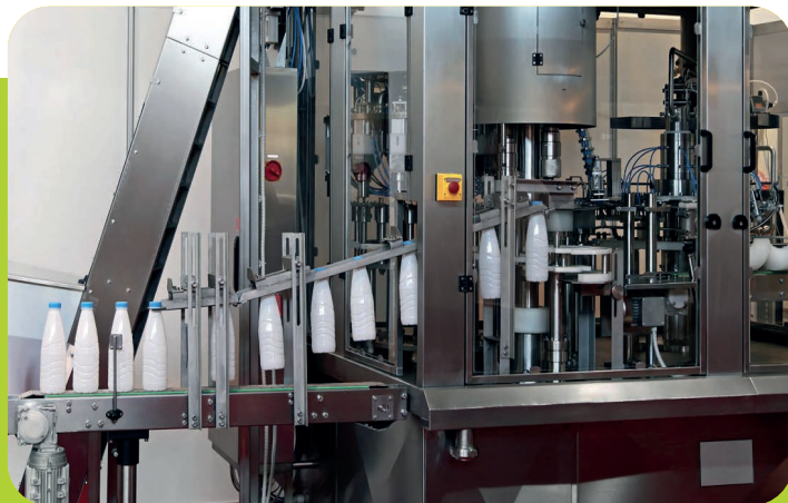
Lubrification de sertisseuses et de convoyeurs par suspension de bouteilles PET en IAA.
