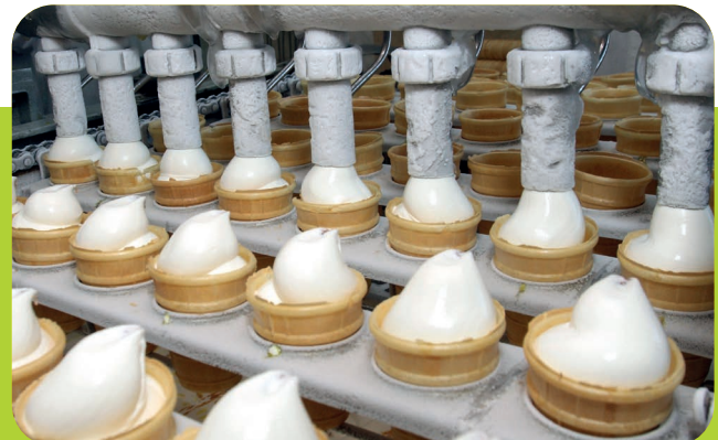
Nettoyage des buses de conditionnement de crème glacée pour une garantie de poids constants.
