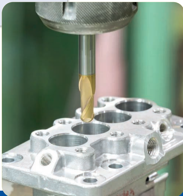
Perçage de centrage sur alliages légers au silicium, série 4000 (aluminiums de fonderie).
